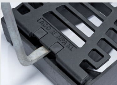
Die schraublose, verkehrssichere Arretierung sichert den Rost gegen Vandalismus, ermöglicht aber gleichzeitig eine leichte Handhabung und Wartung. Der Einsatz von handelsüblichen Aushebeschlüsseln ist möglich. Zum optimalen Handling empfehlen wir die Universal-Handzange mit Haken und Lösehebel.
